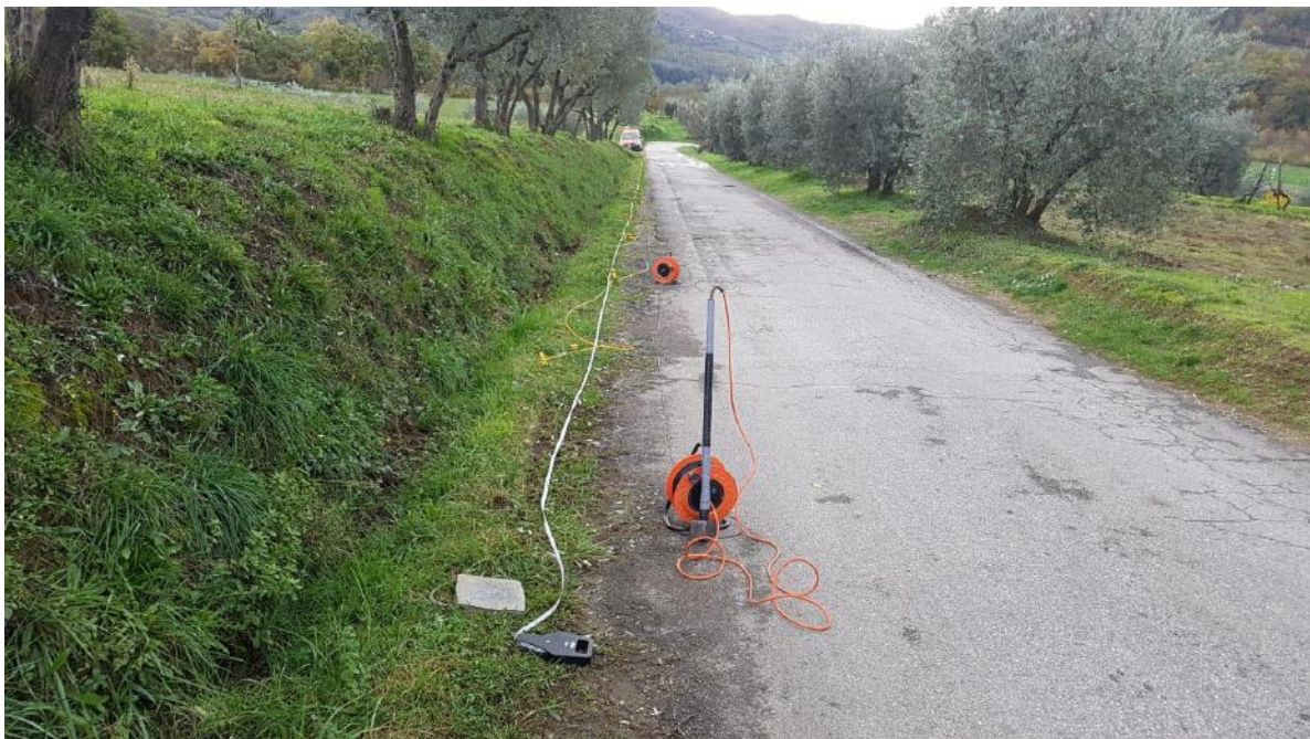
Figura 2: Fase di acquisizione PSI_MASW 2 – Loc. Spedaletto – Subbiano (AR).
